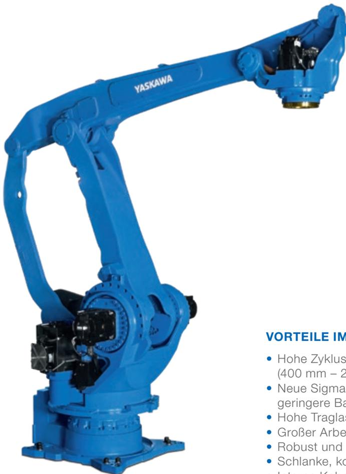
Der schnelle und kraftvolle 4-achsige Roboter MOTOMAN PL190 bietet mit über 1700 Zyklen pro Stunde Höchstleistungen für Box-, Kartonagen- und Gebinde-Palettierungen in den Einsatzbereichen Endverpackung und Logistik.
