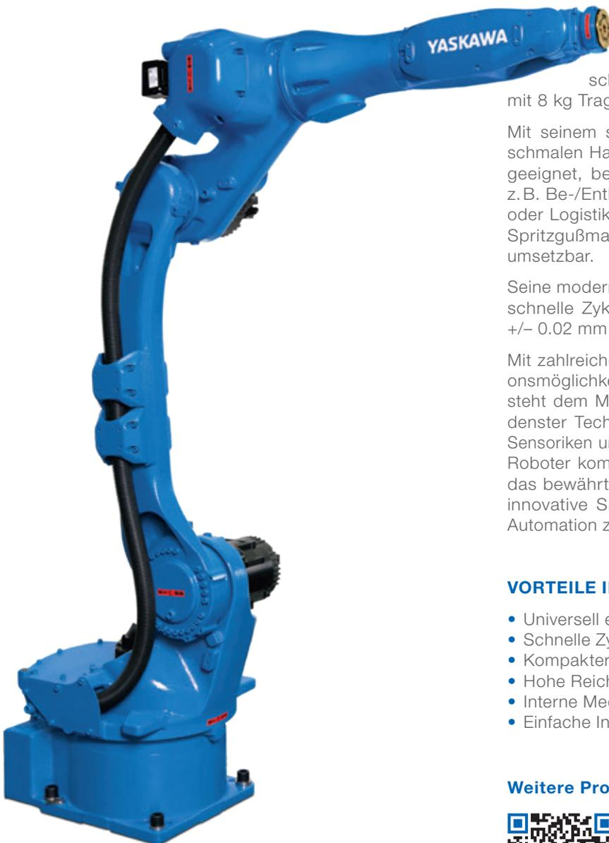
Der 6-achsige MOTOMAN GP8L ist ein schneller, universell einsetzbarer Industrieroboter mit 8 kg Traglast und großer Reichweite von 1.636 mm.
