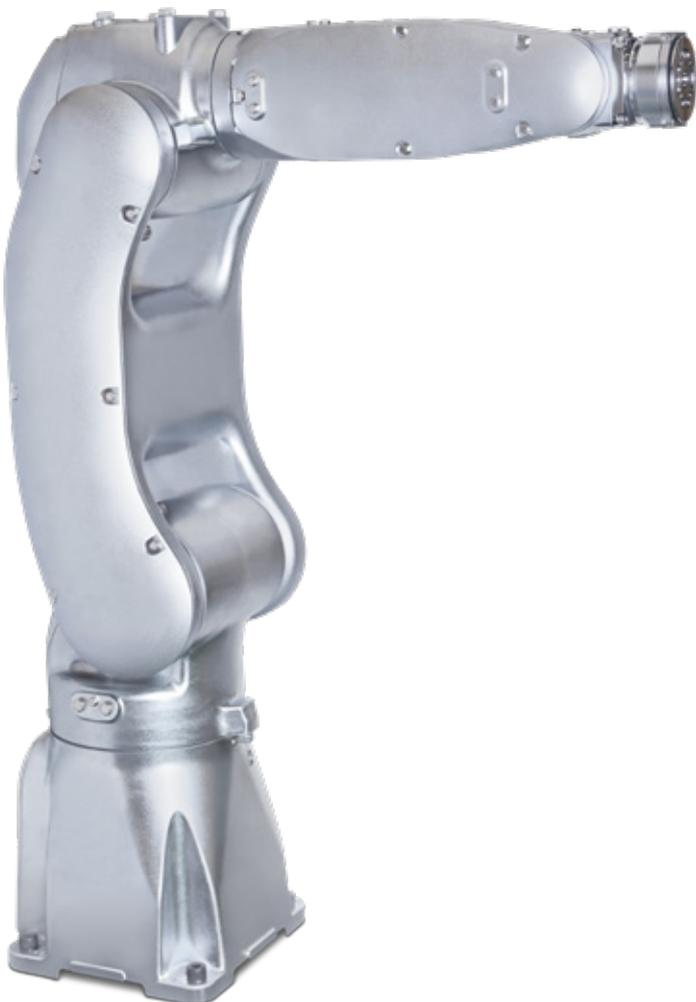
Der MOTOMAN GP8 FGG HS (Food Grade Grease Hygienic Surface) ist ein sehr schneller und präziser 6-achsiger Industrieroboter mit einer Traglast von bis zu 8 kg speziell für die Lebensmittel-Branche. Mit einer Reichweite von 727 mm und einer hohen Wiederholgenauigkeit von  $\pm 0,01$  mm ist er für universelle Handling- oder Verpackungsaufgaben bestens geeignet. Sein modernes, glattes, schlankes und prämiertes Industriedesign gefällt und minimiert den Platzbedarf am Einbauort.
