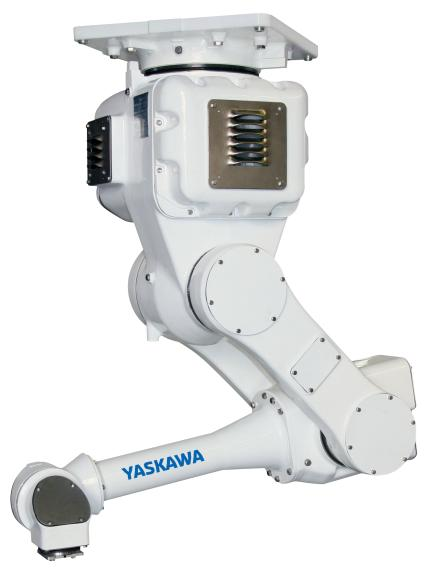
Der MOTOMAN MPK2F ist ein Hochgeschwindigkeits-5-Achs-Roboter, der besonders in den Bereichen Kommissionierung, High-Speed Handling und Picking-Packing sowie anderen Handhabungsapplikationen zur Anwendung kommt.
